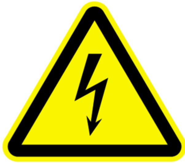
Abbildung 13: Symbol für Spannung
